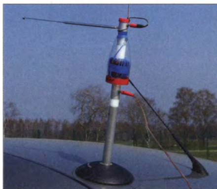
Bild 3: Magnetfußhalter für die Verlängerungsspule samt Teleskopstab
