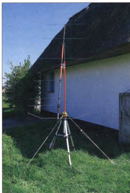
Selbst mit einer solchen, nur knapp 2,70 m langen 7-Element-Yagi-Antenne, ist 2-m-EME möglich.
