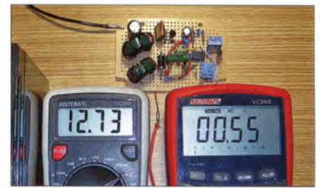
Bild 6: Spannungs- (links) und Strommessung (rechts) am Auffrischer; der real fließende Impulsstrom ist höher als 0,55 A, doch das träge Messinstrument kann der Impulsspitze nicht folgen und integriert ihren Wert über die Zeit. Fotos: Urbanneck
