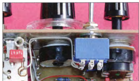
Bild 12: Befestigung und Verdrahtung des AM/SSB-Umschalters Fotos: DG0KW
