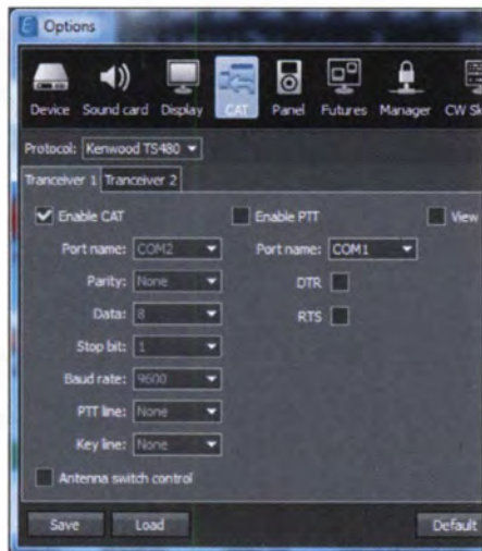
Bild 10: Einstellung der CAT-Steuerung im Programm ExpertSDR2
