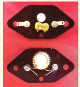
Noch offener Sperrkreis; die 20-W-Version misst 52 mm × 21 mm und wiegt nur 8 g, der 14 g schwere 100-W-Sperrkreis misst 70 mm × 27 mm.
