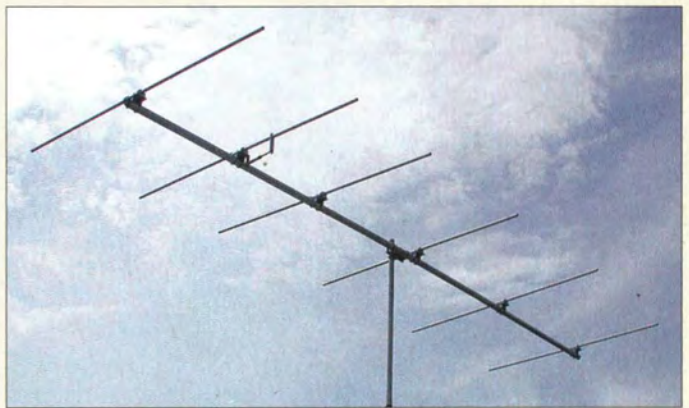
4-m-Band-Antenne ZX4-6 mit sechs Elementen, 5,31 m Boom und 2,85 m Drehradius
