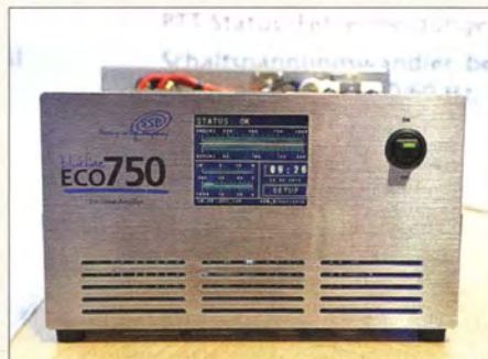
Von außen und innen zu bestaunen war SSB-Electronic's nun lieferbare, wirkungsgradoptimierte 2-m-PA Eco750; die Bedienung erfolgt per aktivem TFT-Touch-Display.
