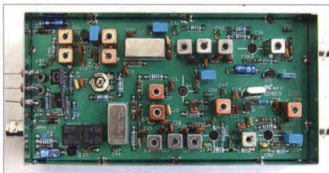
Bild 1: Der Transvertersatz von OZ2M [8], hier betriebsfertig aufgebaut, gibt an der Ausgangsbuchse 100 mW Sendeleistung ab.
