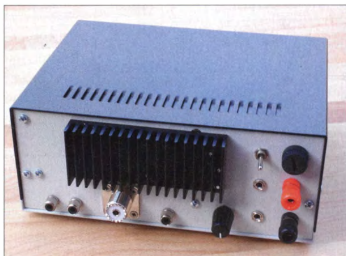
Bild 7: Gehäuserückseite mit Buchsen für 12 V, Morsetaste, Kopfhörer und Antenne sowie HF-Dämpfungsknopf und drei freien Cinch-Buchsen
