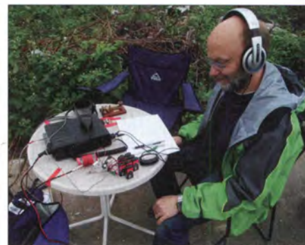
Stationsaufbau auf einem Campingtisch; der Kenwood TS-50 diente als Empfänger. Die Sendempfangs-Umschaltung erfolgte mittels eines Simetochalters auf einer kleinen, mit Isolierband auf den Tisch geklebten Platine. Fotos: DL8DTL, F. Wunsch
