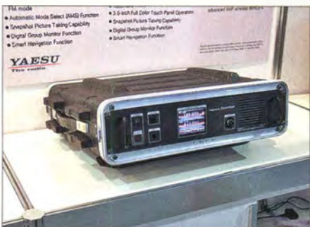
Mit dem preisgünstigen FM/DV-Repeater DR-1 für 2 m und 70 cm will Yaesu sein DV-System C4FM in Deutschland protegieren. Das Gerät eignet sich insbesondere zur Umrüstung vorhandener Relaisfunkstellen.
