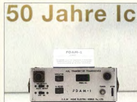
Anlässlich des 50-jährigen Firmenjubiläums zeigte Icom auch historische Technik, hier das Debüt von 1964. Der volltransistorisierte 6-m-Transceiver FDAM-1 machte damals weltweit Furore.
