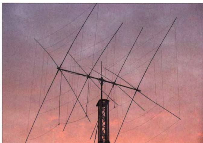
Bild 1: Bei der Träger-Quad (Boom-Quad) für mehrere Bänder sind die Quad-Elemente in parallelen Ebenen auf dem Träger (Boom) angebracht.
