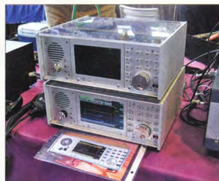
SDR-Empfänger und -Transceiver mit Direktabtastung bis in den UKW-Bereich am Stand von Reuter-Elektronik aus Dessau
