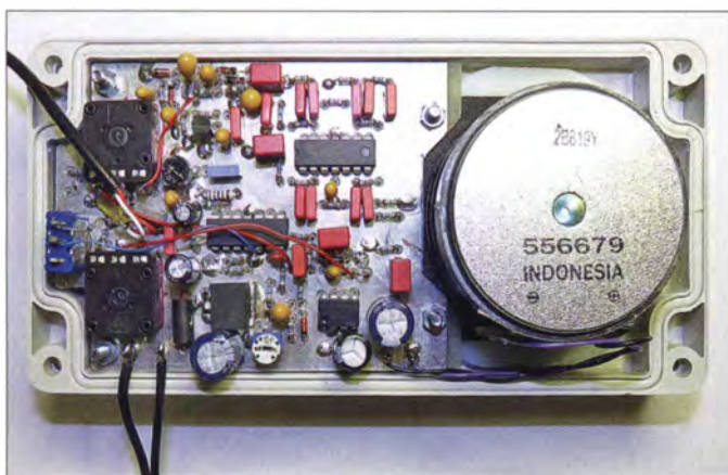
Bild 1: Prototyp der SSB-Rauschsperrung einschließlich Lautsprecher im Kunststoffgehäuse mit abgenommenem Deckel
