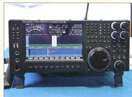
Ein Prototyp des SunSDR-MB1 – ein eigenständiger KW/6-m/2-m-Transceiver mit Direktabtastung im Send- und Empfangszweig bei Expert Electronics aus Russland
