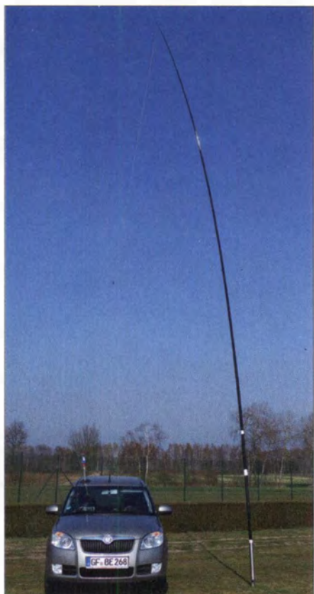
Bild 2: „Stand-Mobil“ mit einem Viertelwellenstrahler neben dem Fahrzeug
