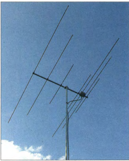
Bild 3: Die Dreiband-Yagi nach DK7ZB für 2 m, 4 m und 6 m [11] gibt es inzwischen auch aus kommerzieller Fertigung – bei WiMo.
