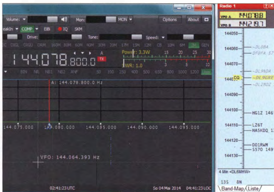
Bild 3: Teil der Bedienoberfläche von ExpertSDR2 mit dem mit der Rückseite der Antenne aufgenommenen Signal von DF0FA bei 144,064 MHz
