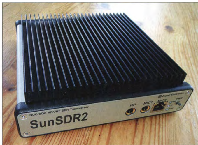
Bild 1: Frontseite und großer Kühlkörper des SunSDR2
